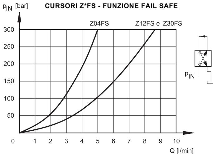
Portata  $P \rightarrow B / A \rightarrow T$  con valvola in posizione di emergenza (fail safe) in funzione della pressione in ingresso.
