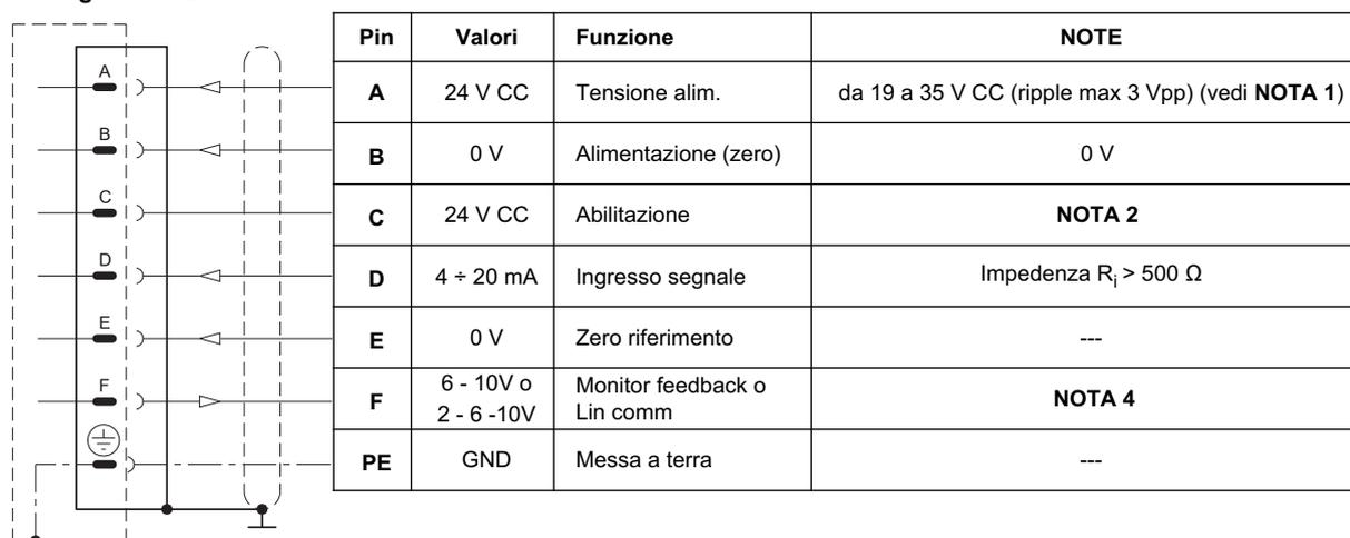
**NOTA 1:** prevedere sul pin A (24 V CC) un fusibile esterno a protezione dell'elettronica. caratteristiche del fusibile: 5A/50V tipo rapido.
